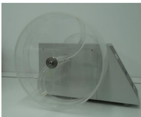
20.ábra: Kopási veszteséget vizsgáló berendezés
